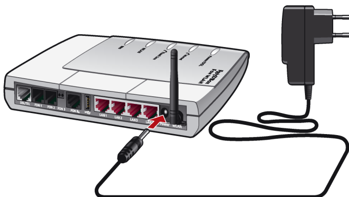
Collegamento alla rete elettrica
