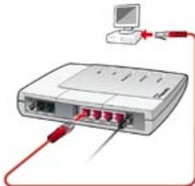
Collegare il proprio PC al FRITZ!Box Fon 5124 tramite una porta di rete (indifferentemente "LAN1", "LAN2", "LAN3", "LAN4") utilizzando il cavo rosso in dotazione.
